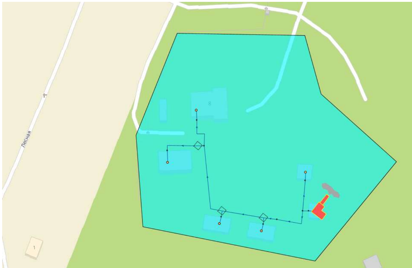
Рисунок 4.26 – Зона действия котельной ОЦ «Голубь»
